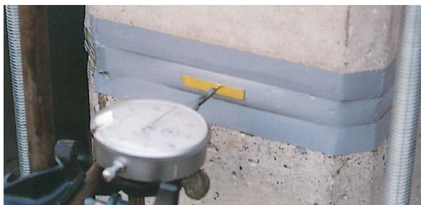
低モジュラスシーリング材を使用した場合の背水圧によるふくれ (目地形状20×20mm、0.1MPa、4.1mm)
