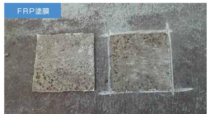
■FRP密着防水のコンクリート躯体内部の水分(スラブ面が濡れている)
